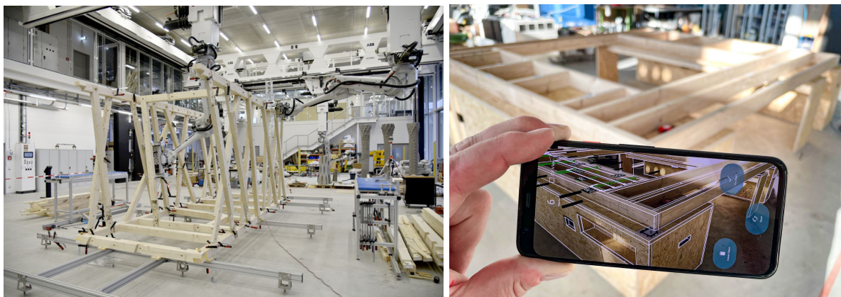
Links: Roboterbasierte Montage von Holzelementen im Robotic Fabrication Lab der ETH Zürich. Rechts: Augmented Reality unterstützte manuelle Assemblierung.
